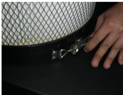
Figure 42 : Desserrer le collier de serrage du sac de collecte
