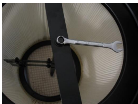
Figure 43 : Retrait du boulon d'articulation du volet (par le dessous)
