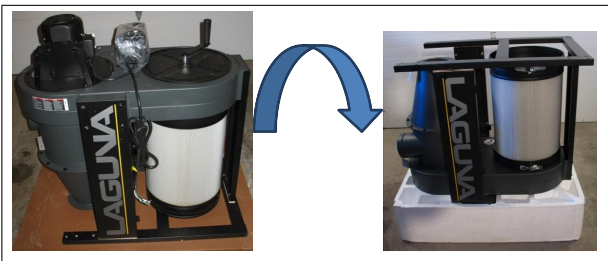
Figure 7 : Mise en place de l'élément principal pour l'assemblage à l'envers
