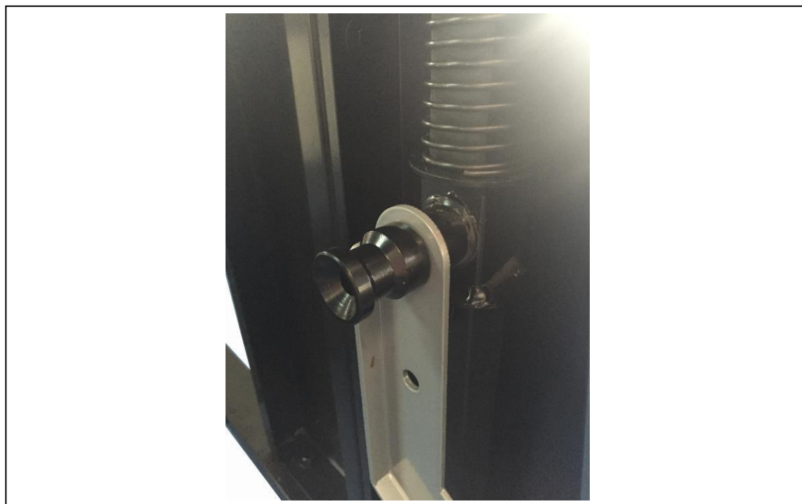
Figure 19 : Fixation de la garniture à l'écrou de la barre de pédale
