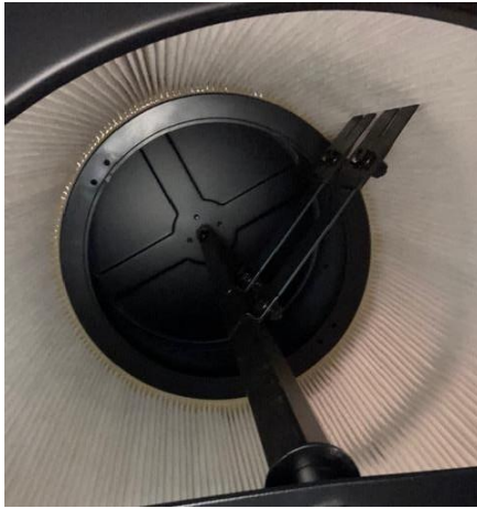
Figures 45-46 : Démontage du filtre extérieur pour le nettoyage
